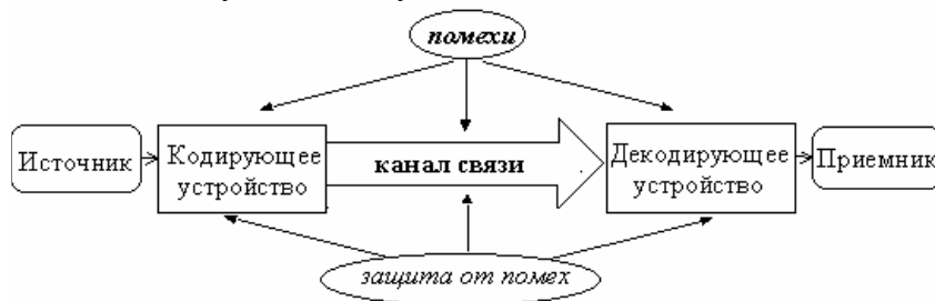
Рис. 5 Процесс передачи информации
