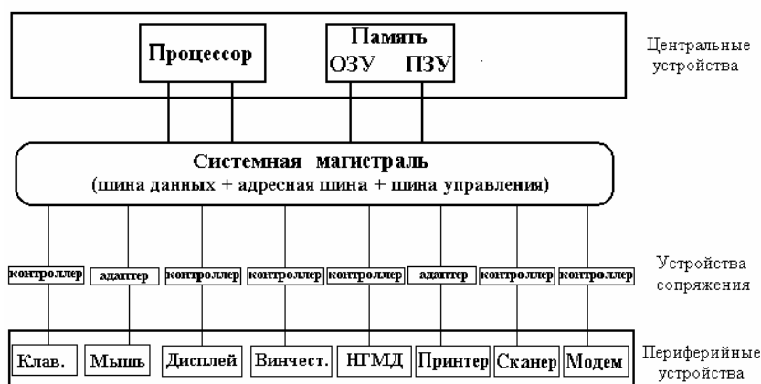
Рис. 12 Схема архитектуры ПК, основанной на магистрально-модульном принципе организации обмена информации:
