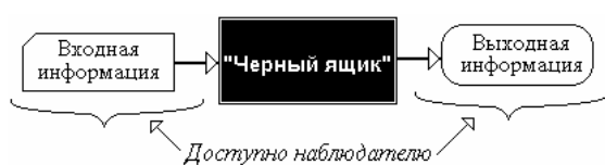
Рис. 7 Схема преобразования информации по принципу "черного ящика"
