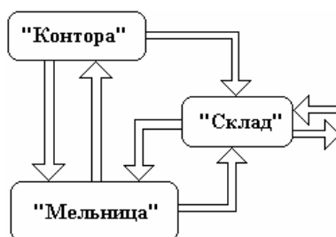
Рис. 9 Архитектура аналитической счетной машины с точки зрения Ч. Бэббиджа
