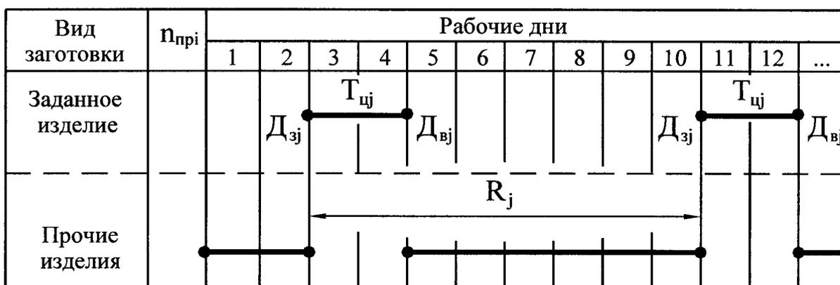
Рис. 2.3. Пример стандарт-плана работы многопредметной поточной линии
