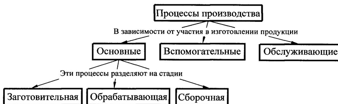
Рис. 1.1. Классификация процессов производства
