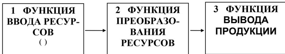
Рис. 1.2 Родовые функции производственной системы
