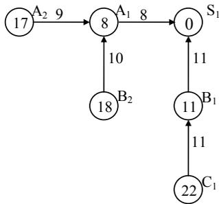
Рис. 6.6. Сетевая модель операции, шаг 2
