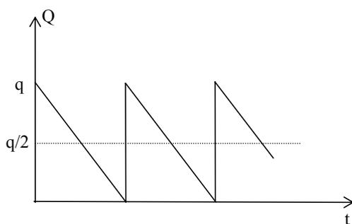
Рис. 4.1. График функции изменения запаса основной модели
