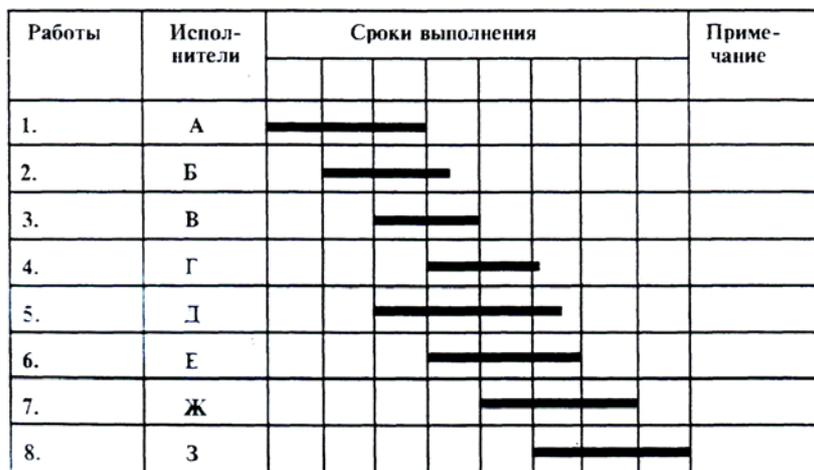
Рис. 22. Ленточный график контроля выполнения комплекса работ
