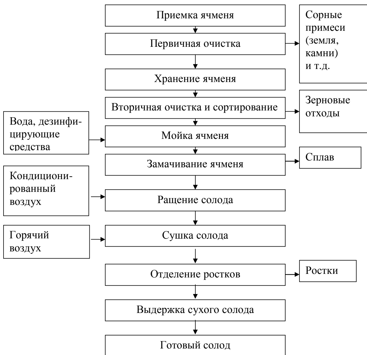
Рисунок 4 – Технологическая схема производства солода.
